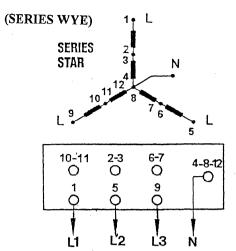
50 Hz L-L 400 volts 50 Hz L-N 230 volts
