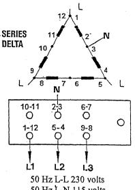
50 Hz L-L 230 volts 50 Hz L-N 115 volts 60 Hz L-L 277 volts 60 Hz L-N 138 volts
